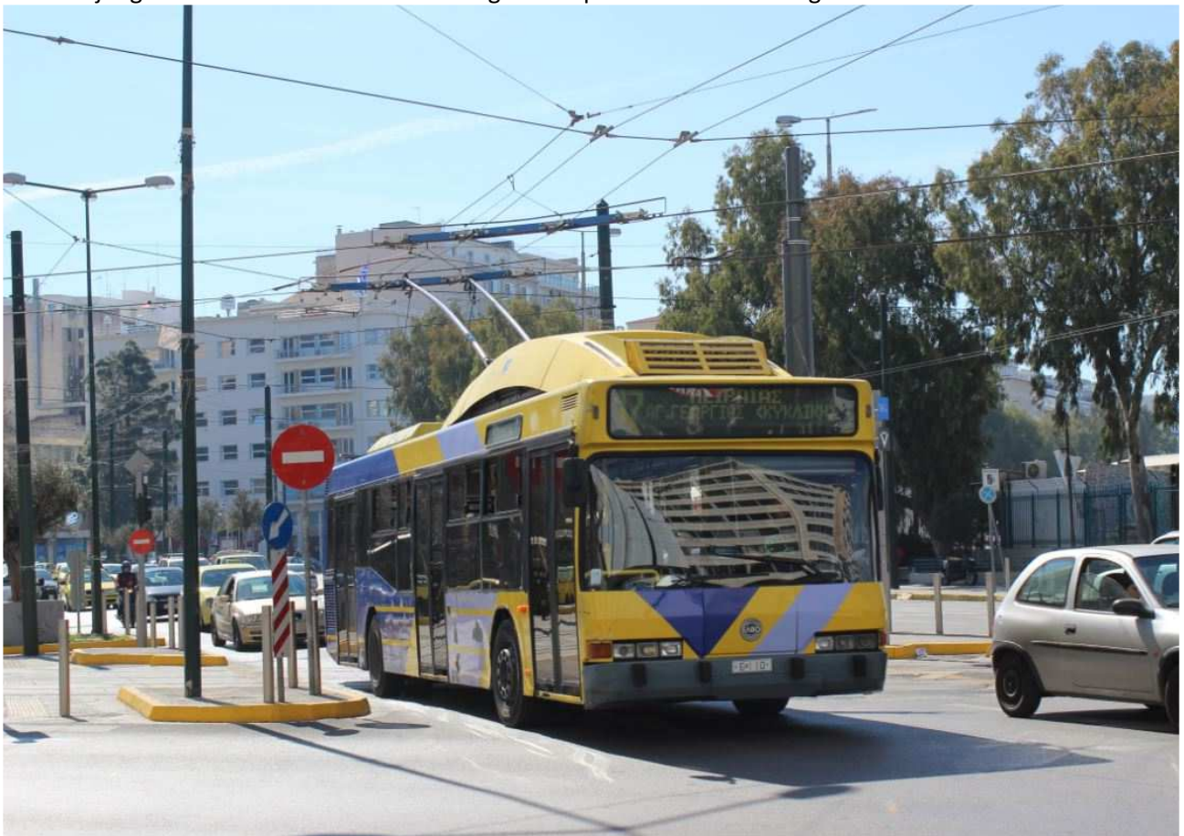
Neoplan-Trolleybus 6110 passiert die Kreuzung mit der Strassenbahn-Oberleitung, diese sollten die Straßenbahnen stromlos passieren, aber hier wurden Schwierigkeiten befürchtet und in der Betriebsruhe von 0 bis 4 Uhr am 27.02.2020 wurden nun neue Kreuzungen eingebaut, die nun von den Trolleybussen stromlos passiert werden müssen, die hier notfalls ihren Hilfsantrieb nutzen können. Foto: J. Lehmann
