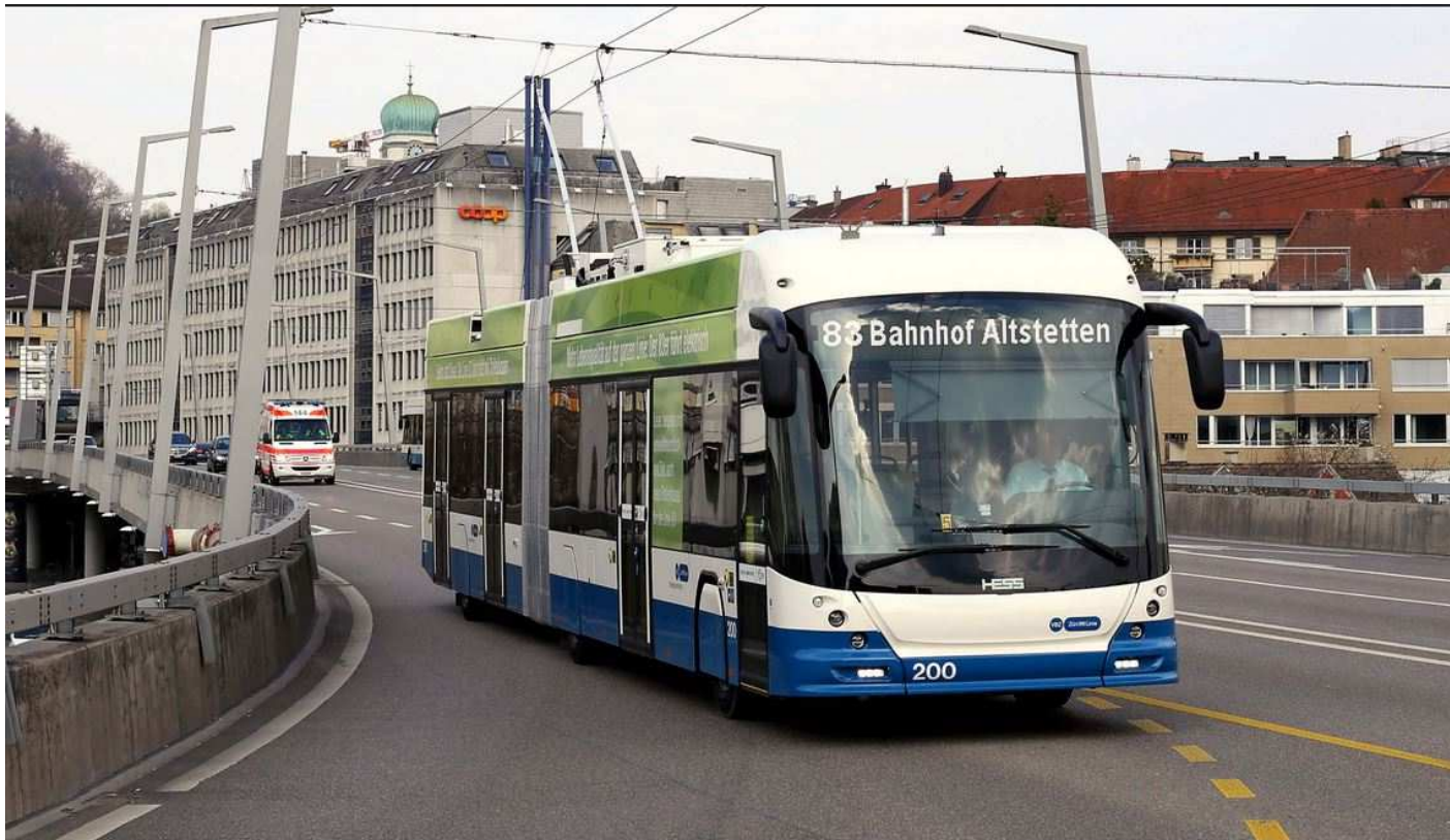
Der Batterie-Trolleybus lighTram® 19 DC 200 fährt im Einsatz auf der Linie 83 die Haltestelle Escher Wyss Platz an. Foto: VBZ/Hess
