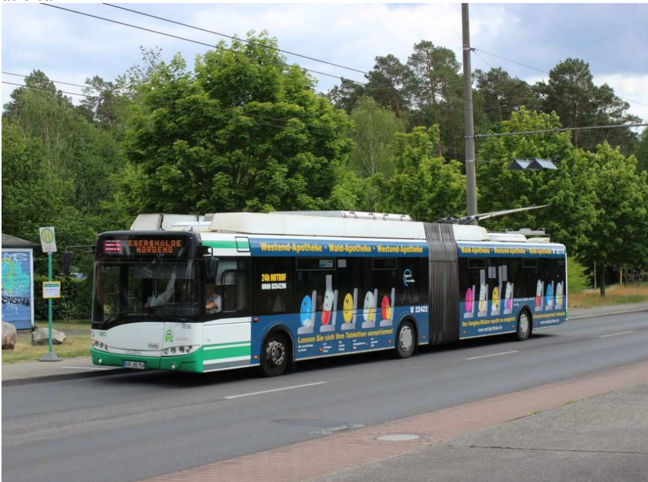
Auf der Spechthausener Straße ist für den Eindrahtungsvorgang - hier mit Wagen 056 - eine Haltestelle eingerichtet worden, die jedoch nicht für den Ein- und Ausstieg vorgesehen ist. Foto: J. Lehmann, 08.06.20
