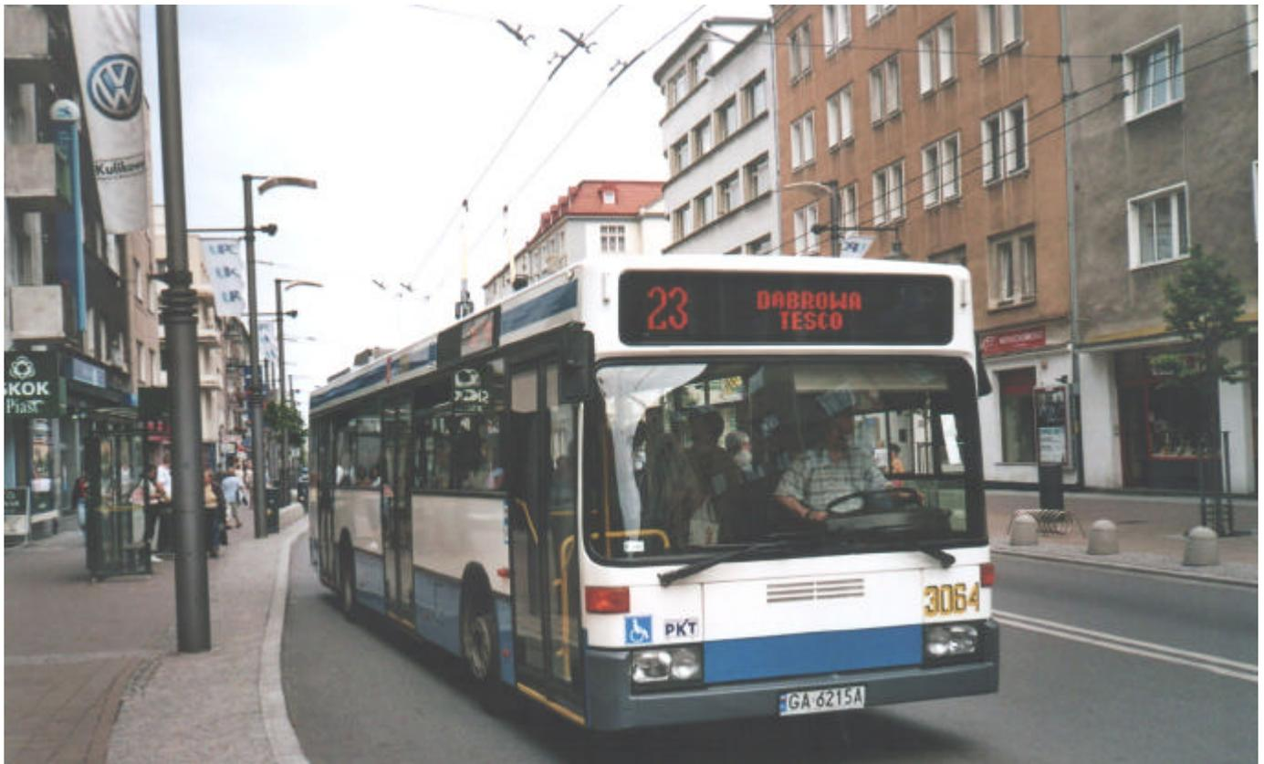
Dreitürige Mercedes-Benz-Dieselmotoren erhalten in Gdingen ein zweites Leben als Trolleybusse. Insgesamt sind 10 gebrauchte Dieselmotoren aus Deutschland seit 2004 umgebaut worden, Obus 3064, hier am 22.06.2006 in der Innenstadt von Gdingen, verkehrte von 1993 bis 2003 als Dieselmotoren beim Kraftverkehr Bayern.
